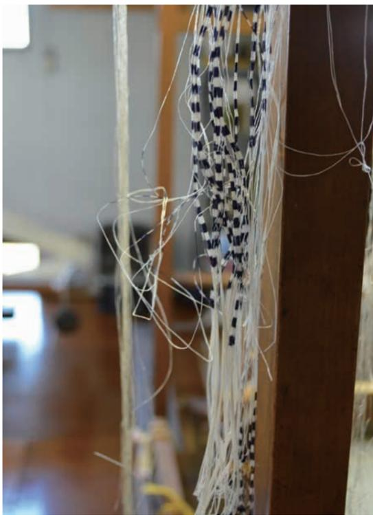
図6 板締で染めた糸（小松織物工房）
