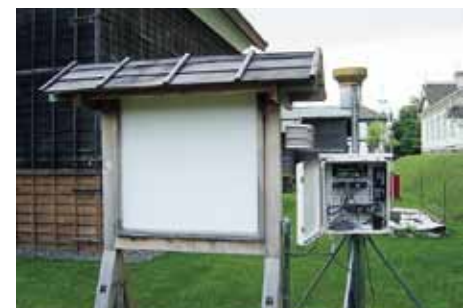
写真3 屋根を付けて屋外に設置した試験土壁と計測機器
