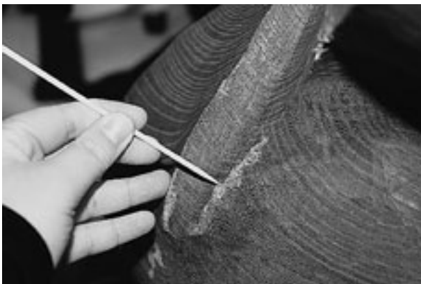
こびり付いたパルプ繊維と汚れ
