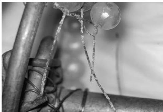
図10 針金の腐食による模造真珠の落下（「カヌー」）
