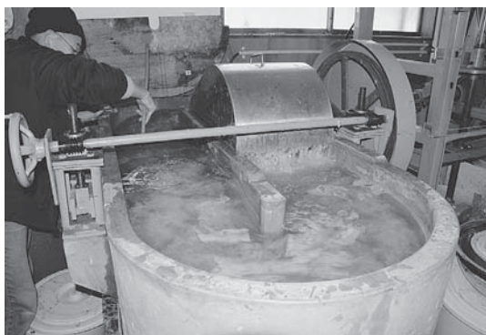
図8-5 ホレンダーピーターによる叩解
