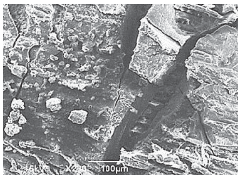
図6-5 膠片に発生したひび割れ
