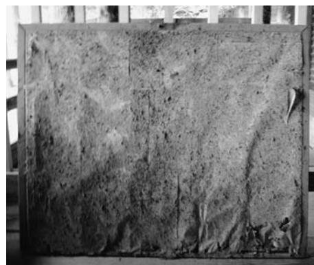
図4-55 裏面に蓄積された塵埃などの汚れ
