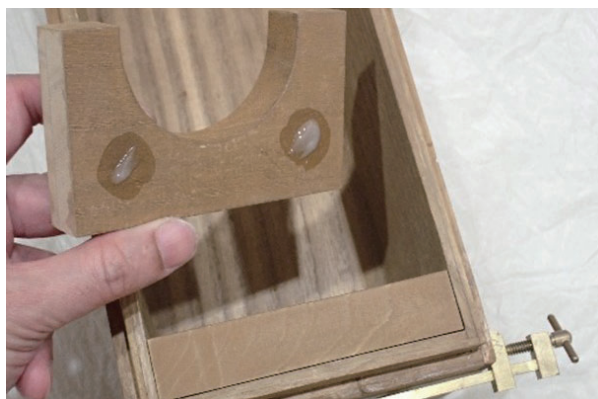
図102. エポキシ系接着剤による接着
