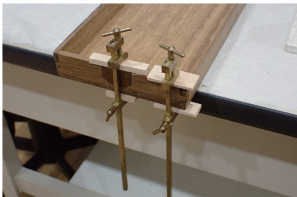
図99. 接着・ハタガネ固定
