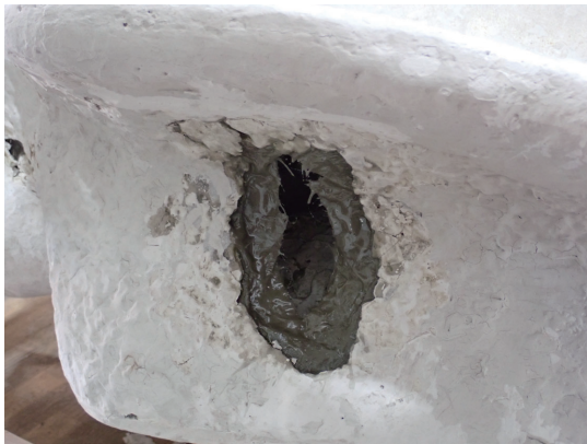
図13 ガラスクロスを貼って補強した状態（翼上面）
