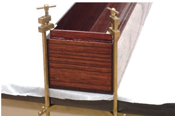
図79. 接着、ハタガネ固定
