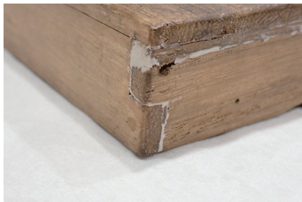
図100. 人工木材充填
