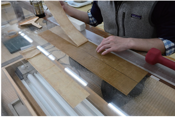
図59. 裂の裏打紙除去
