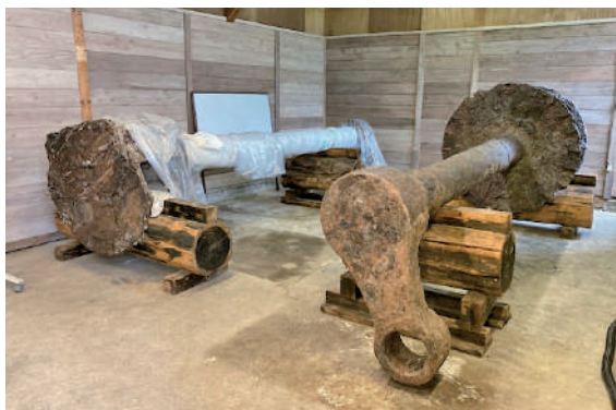
図7 順動丸シャフト 表面処理後（右側）
