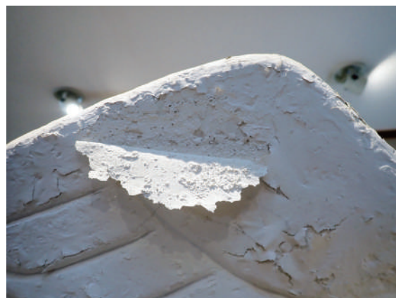
▲図1 翼の白色材剥離
