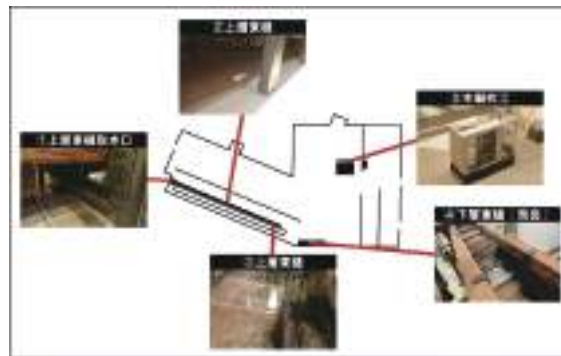
写真2 追加した温湿度データロガー設置箇所
