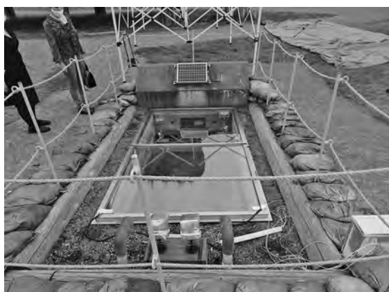
写真5. タイムラプスカメラ、温湿度測定装置の設置状況
