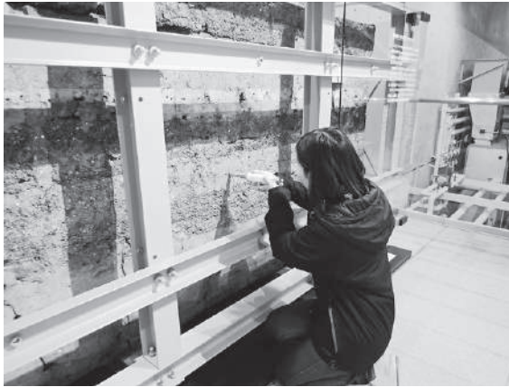
写真7. 試験体の強度試験
