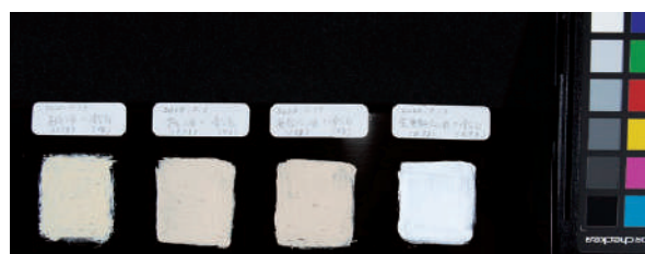
図26. 塗布直後（右から生油、亜麻仁油、荏油、桐油）
