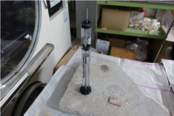
図7. ミニディスクインフィルトメーターを用いた測定の様子
