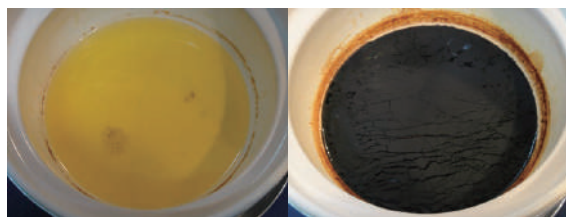
図21. 荏油 加熱前→加熱後
