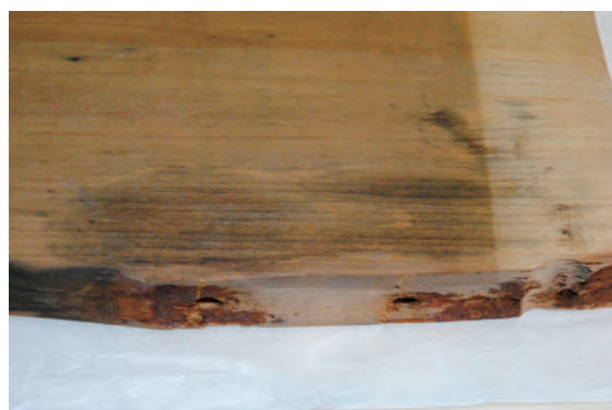
写真11 椅子部背もたれ 鉄汚染漂白後
