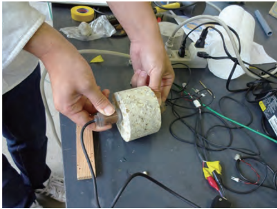
図23. 劣化度の低い成沢地区凝灰岩の音波伝搬速度の測定をしている様子
