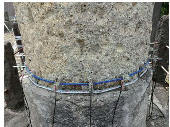
図15. 音波の発信・受信兼用センサーの設置
