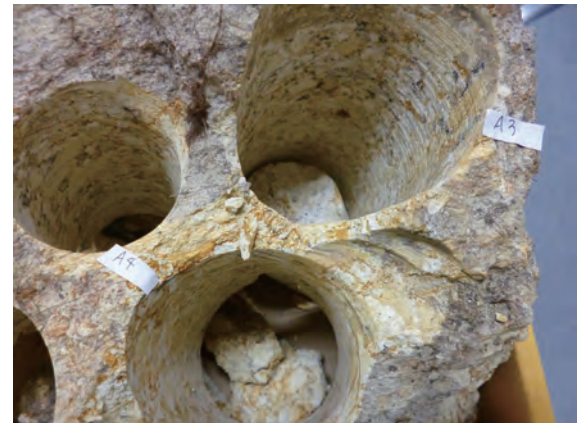
図10. 劣化度の高い成沢地区凝灰岩試料の石材表面状況
