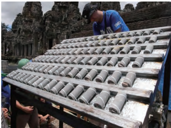
図12. 試験体に保存材料を含浸、耐候試験
