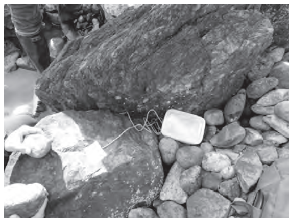
図2. 遣水下流部分の景石表面および地表面温度測定
