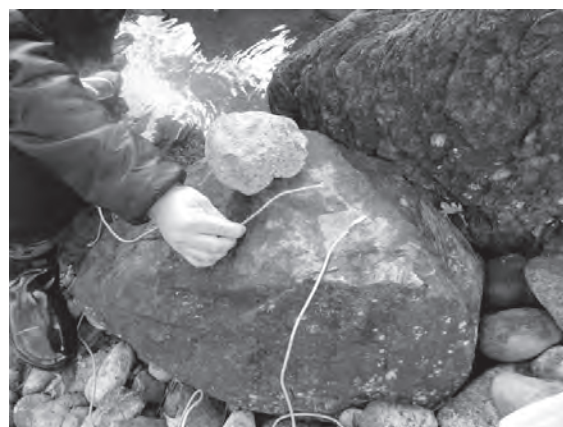
図4. 遣水下流部分の地表面温度測定センサーのコードが小動物により切られていた様子
