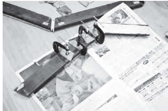
写真3 C型クランプでの圧着
