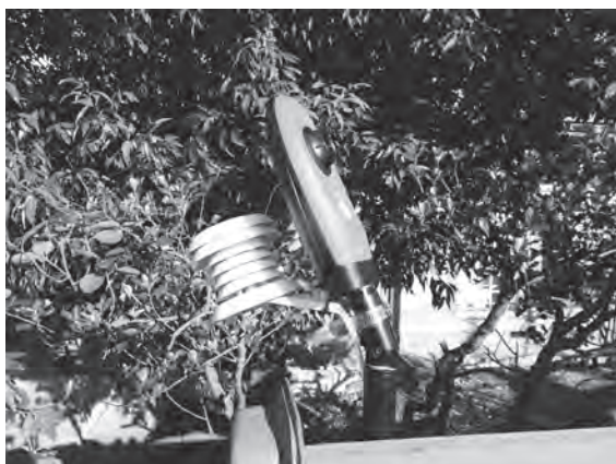
写真5、タイムラプスカメラおよび、シールド内に設置した気温、湿度の測定のためのセンサーの様子
