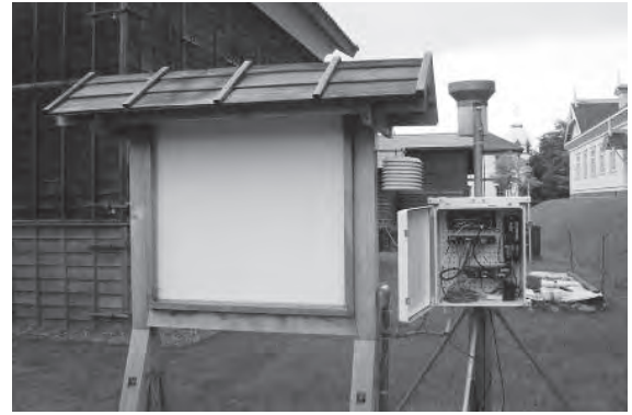
図9. 屋根を付けて屋外に再設置した試験壁と計測機器の外観
