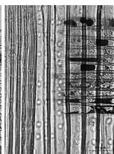
写真6. 天衣部材の顕微鏡写真【アスナロ属】（左より、木口、柃目、板目）
