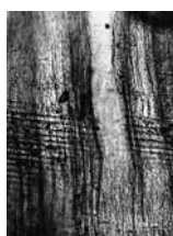
写真18. 法輪寺毘沙門天像 体幹部材【サクラ属】（左から木口、柃目、板目）
