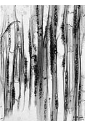
写真8. 背板補修部材の顕微鏡写真【カツラ】（左より、木口、柃目、板目）
