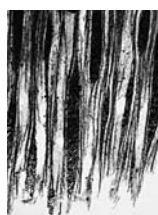
写真18. 法輪寺毘沙門天像 体幹部材【サクラ属】（左から木口、柃目、板目）
