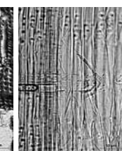
写真20. 法輪寺毘沙門天像 米俵台座材【ヒノキ】（左から木口、柃目）
