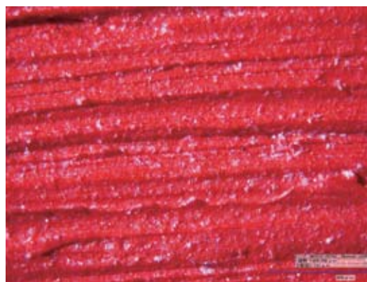
図20 筆で除去後 ×160 完全には除去出来ず、結晶が残っている状態
