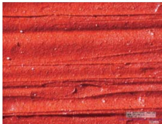
図21 熱による処置後 ×80 残っていた結晶が融解された
